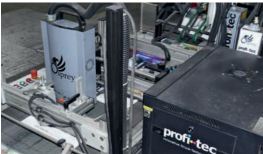
Der MCS-Osprey-Druckkopf eignet sich insbesondere für das Adressieren von Zeitschriften und Katalogen.
