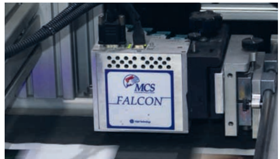
Der zweite HP-Druckkopf vom Typ Falcon dient für die einfache und schnelle Herstellung farbiger Eindrücke.
