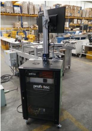
Mit dem mobilen Controller für die Falcon-Druckköpfe ist das System, wie auch das UV-System, in verschiedenen Fertigungslinien einsetzbar. Die Falcon-Einheit verwendet HP-Inkjet-Patronen mit wasserbasierter Tinte und braucht keinen UV-Trockner.
